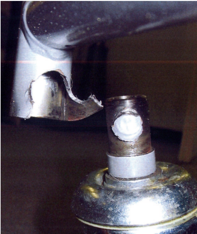
Das Foto zeigt eine ausgebrochene Radaufnahme an einem Toilettenrollstuhl.
