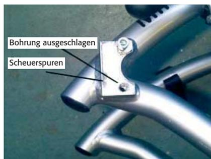
Auf Grund einer gelockerten Verschraubung hatte sich das Rad aus der Aufnahme gelöst.
