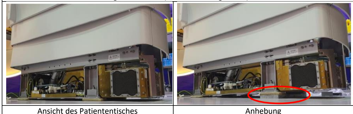
Abbildung 1: Beispiel einer solchen Bodenplatte des Patiententisches, durch die der Tisch angehoben wird (siehe Abbildung rechts).
