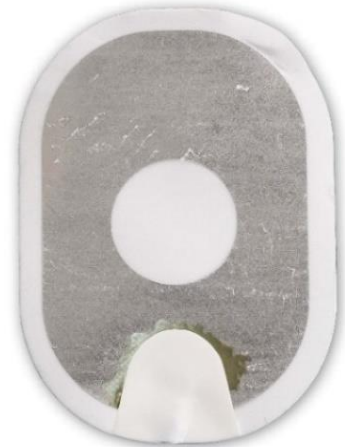
Abbildung 3: Gel fast vollständig von Folie abgelöst.
